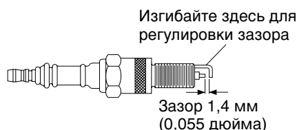
Рис. 12. Регулировка зазора свечи зажигания, нагреватель мощностью 10 кВт
